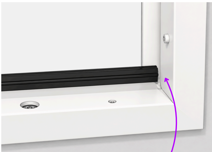
Alumise tihendi lõikepikkus ja lõikamise viis (90 kraadine lõige) Cutting length and cutting method of the bottom gasket (90° cut)
